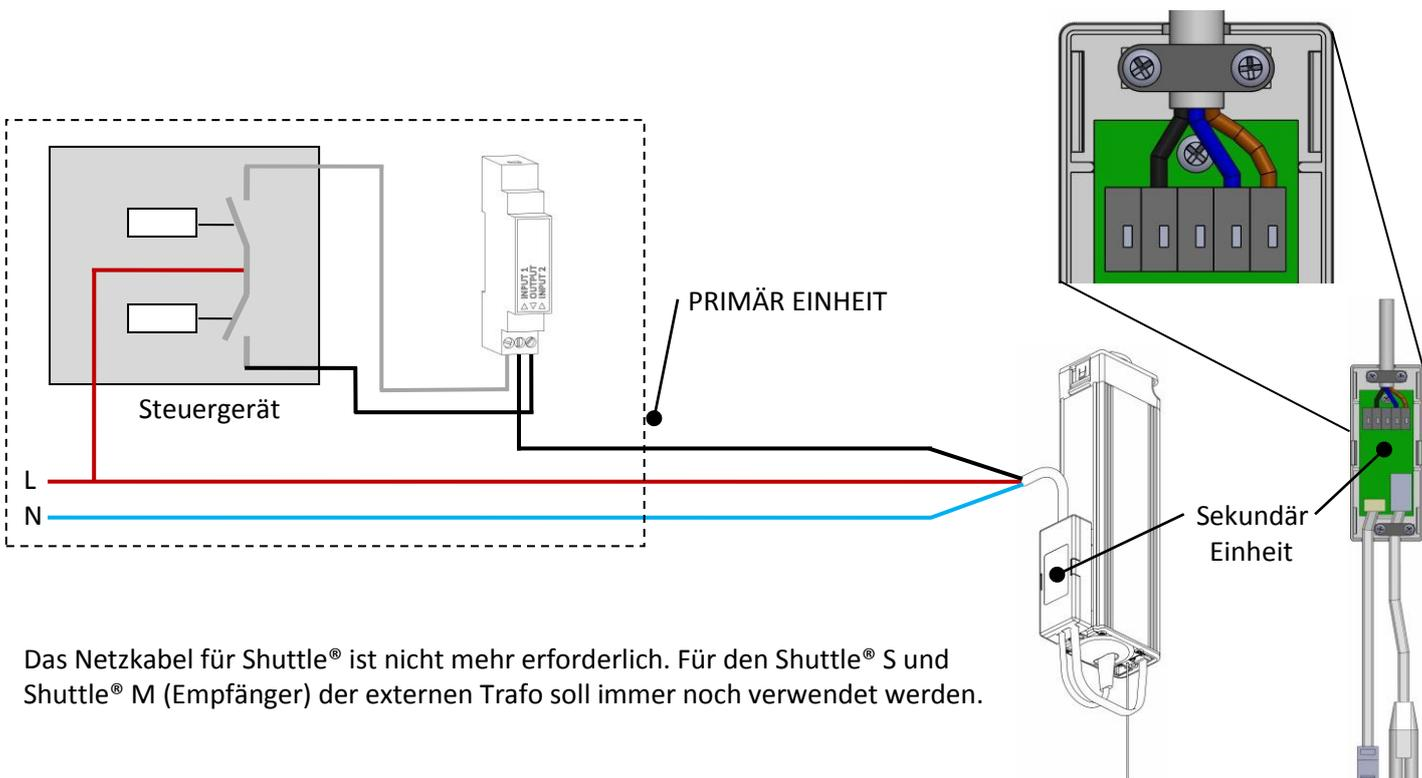
Das Netzkabel für Shuttle® ist nicht mehr erforderlich. Für den Shuttle® S und Shuttle® M (Empfänger) der externen Trafo soll immer noch verwendet werden.
